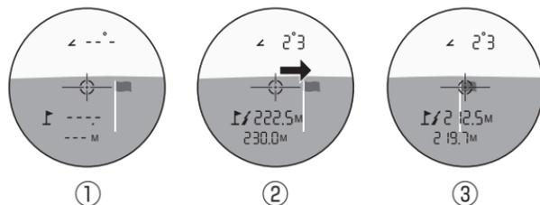
ターゲットがピンのように細く、ターゲットマークを合わせにくい場合はスキャンモードで測定をします。
