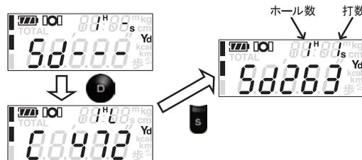
2打目以降の場合も飛距離測定画面に切り替え、1打目と同様に、操作してください。ホールを移動すると飛距離測定は終了します。
