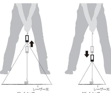
ラインパターンの前後の比率は、レーザー放射口の向きで調整できます。
